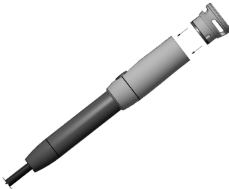
Rysunek 6.4 Sposób instalacji nakładki sondy
